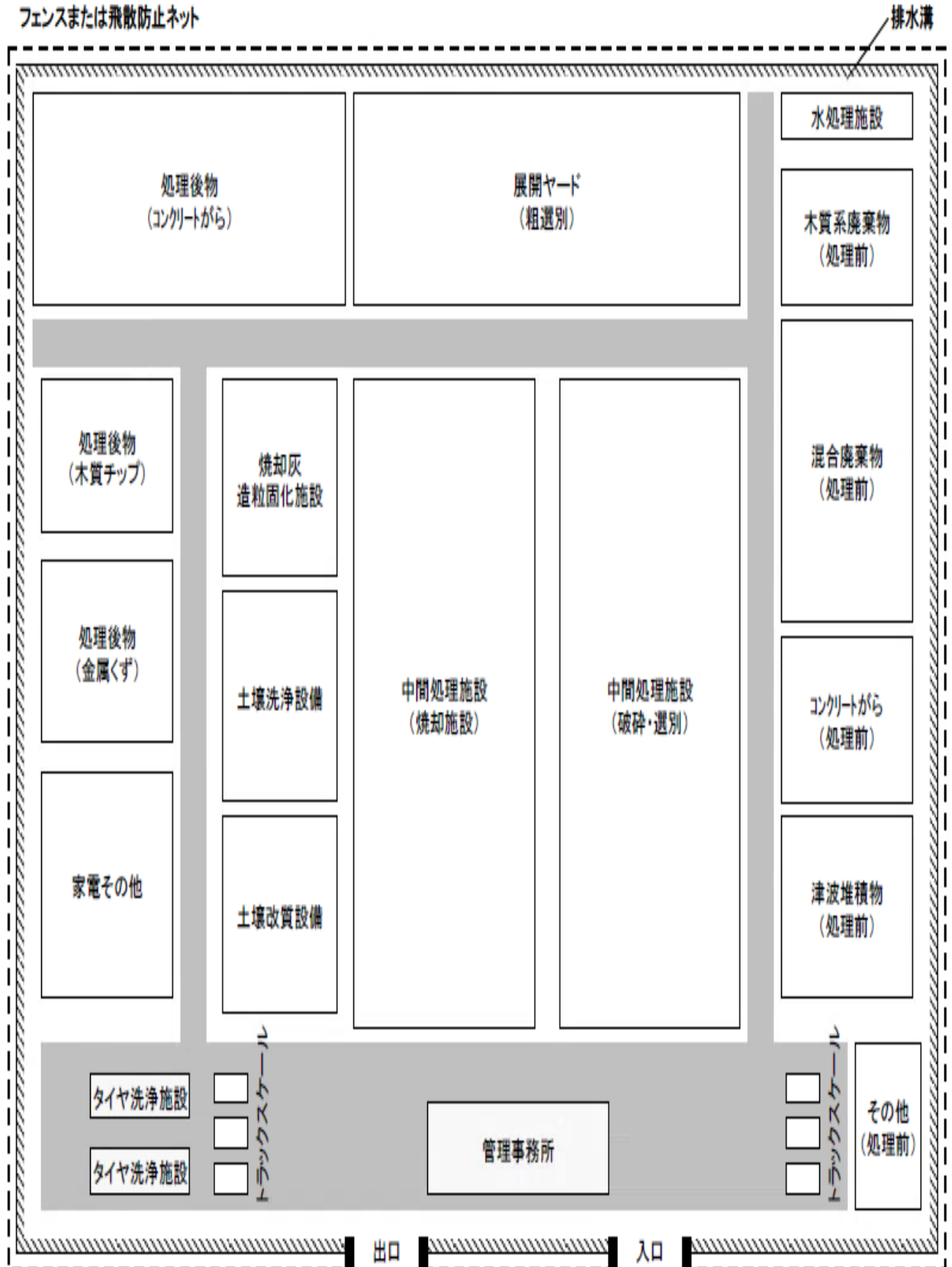
【図4-2 二次仮置場の配置図（例）】 （環境省災害廃棄物対策指針 技術資料 1-14-5）
