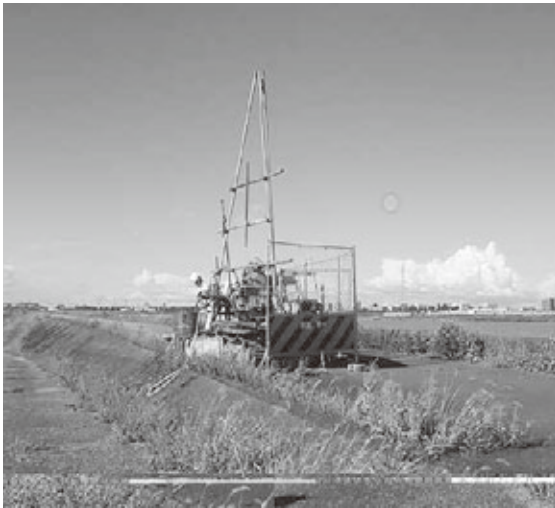
▲石浜地区の海岸堤防のボーリング調査
