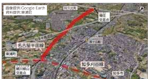
名古屋半田線…延長:約2.4km(東浦町:約1.2km、阿久比町:約1.2km) 幅員:22m(4車線・中央分離帯あり) 知多刈谷線…延長:約1.2km(鉄道高架影響部:約0.4km) 幅員:一般部23m(2車線) ※知多市境から名古屋半田線区間高架部11m(名鉄河和線道路高架)
