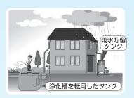
新たに下水道に接続するときは、家庭の浄化槽を雨水貯留浸透施設へ転用しましょう。
