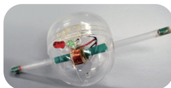
フルフル発電機
